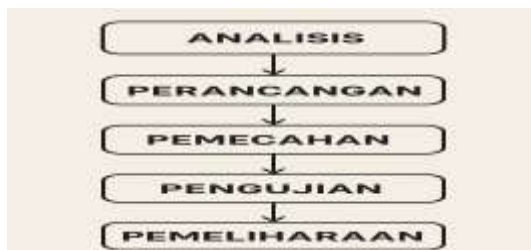
Gambar 2. Model Pengembangan Sistem Waterfall
