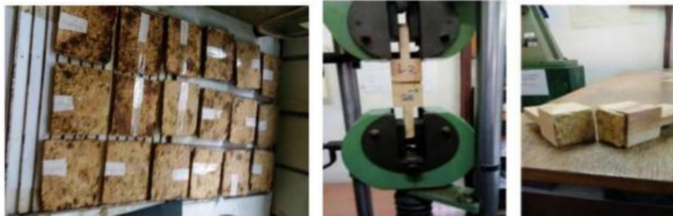
Gambar 10 Test setup papan partikel MC uji IB, Gambar 9 Hasil percobaan papan partikel tongkol jagung. (Dagne 2021)
